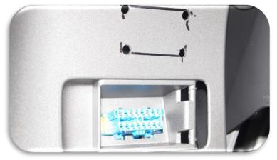
Halterahmen als Schablone auflegen und anzeichnen. Öffnung in Verkleidung herstellen mit z.B. Multirotationswerkzeug (Dremel)
