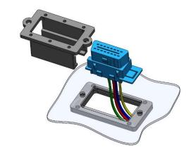
Halterahmen auf die Rückseite der ausgesparten Verkleidung legen und Buchse durchführen. Schieben Sie die OBD-Buchse in das OBD-Saver Gehäuse.
