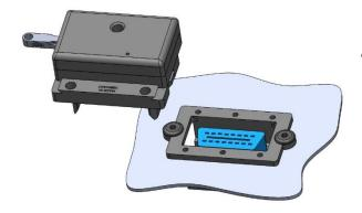
Stecken Sie das Schlosssystem auf und befestigen es mit den M3 Schrauben.
