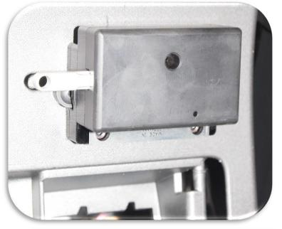
Oberen OBD-Saver (Schlossteil) aufstecken und mit drei Schrauben verschrauben.
