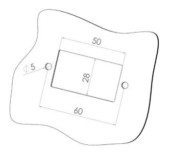
Suchen Sie in der Nähe der originalen Buchse eine passende Stelle, wo Sie die Aussparung in der Kunststoffarmatur einbringen können. (hinter der ausgewählten Stelle müssen min. 28 mm frei sein)
